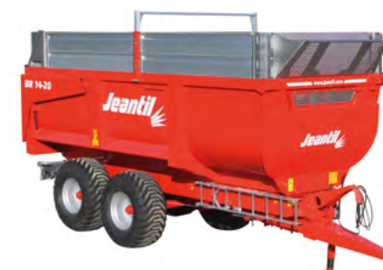
Caisse ht. 1 380 mm avec 600 mm de rehausses
