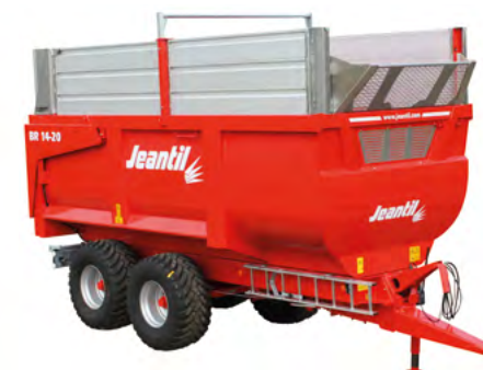
Caisse ht. 1 580 mm avec 900 mm de rehausses
